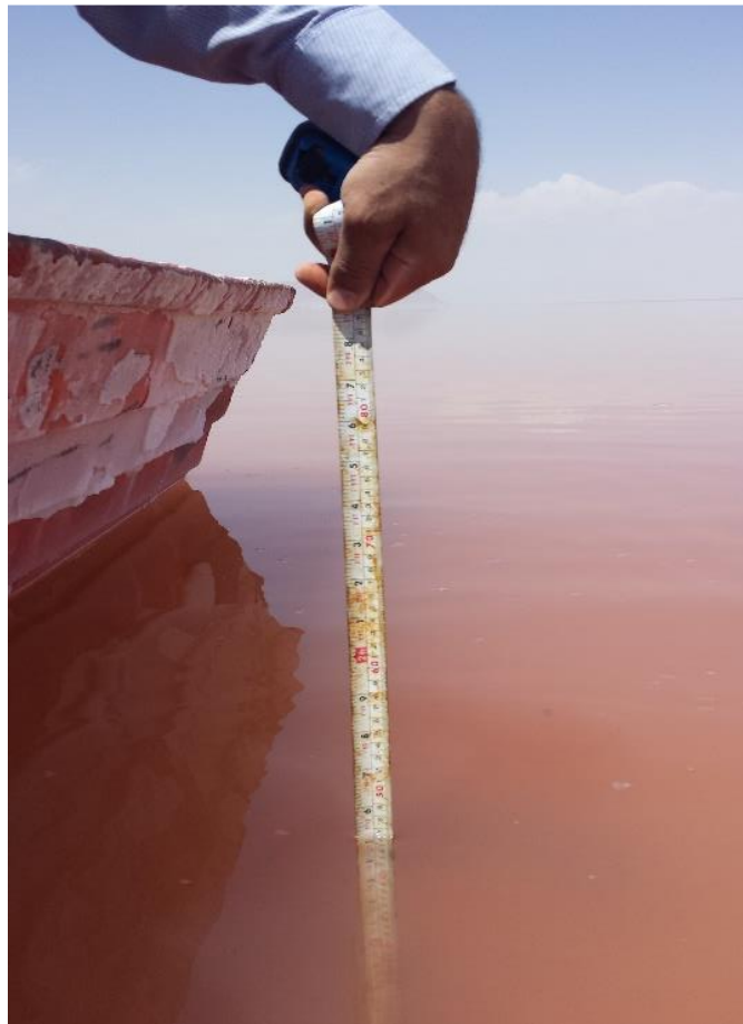
شکل ۲. کنترل عمق آب در حین داده برداری در دریاچه ارومیه توسط کارشناس ناظر سازمان نقشه برداری
