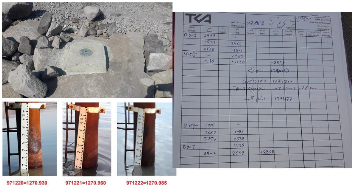
شکل ۱۶. تصاویر بنچ مارک و ثبت تغییرات تراز سطح آب از روی اشل نصب‌شده در ستون پل شهید کلانتری
