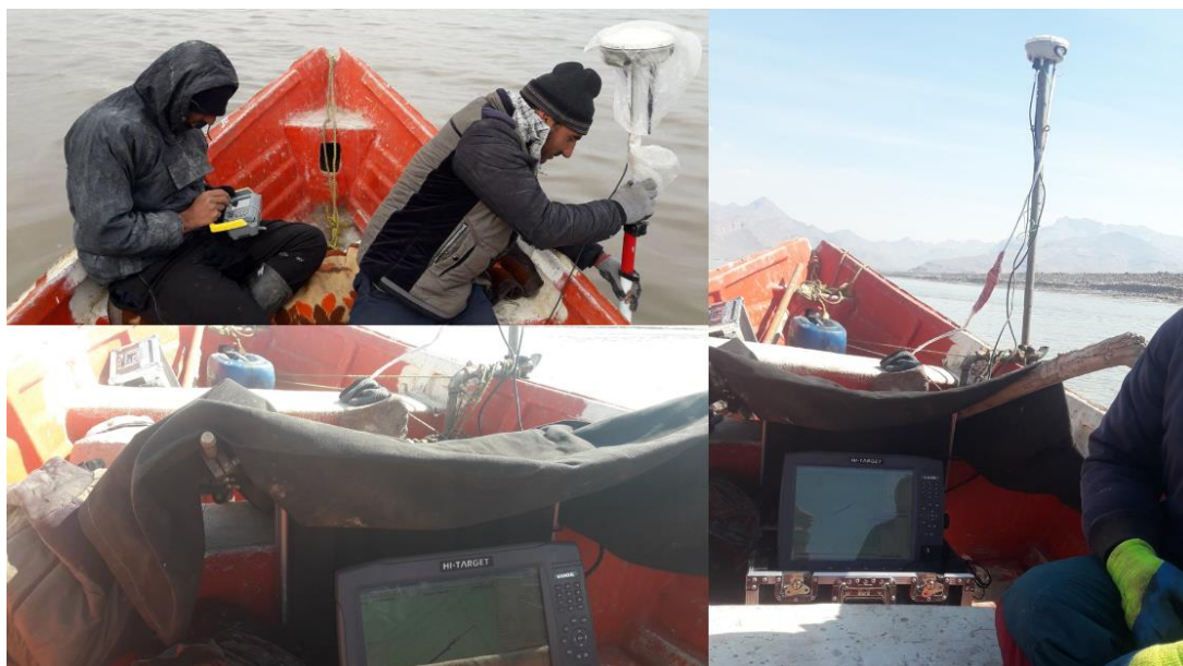
شکل ۱۴. تصاویری از عملیات هیدروگرافی و نقشه‌برداری به روش RTK در دریاچه
