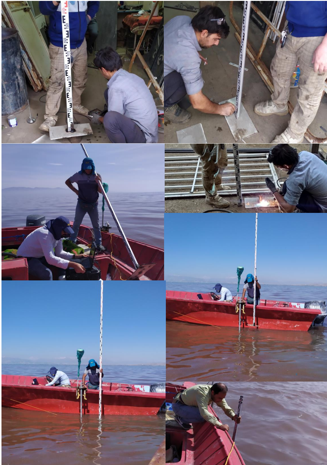
تصاویر طراحی و ساخت و استفاده خطکش مخصوص برای تعیین عمق در به دست آوردن سرعت صوت
