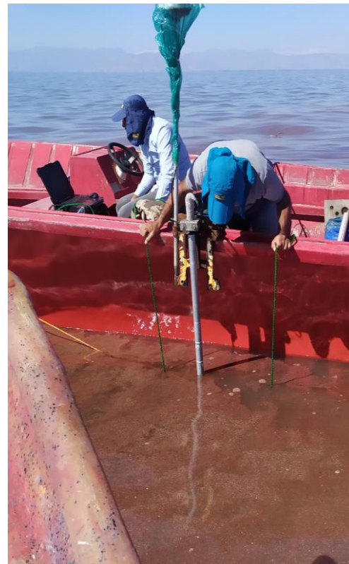
تصاویر بارچک زدن و بررسی سرعت صوت در آب در دریاچه ارومیه
