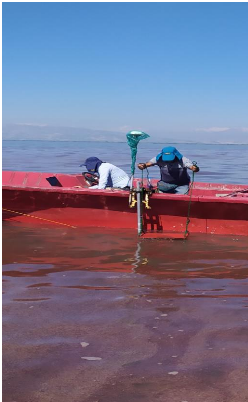
تصاویر بارچک زدن و بررسی سرعت صوت در آب در دریاچه ارومیه
