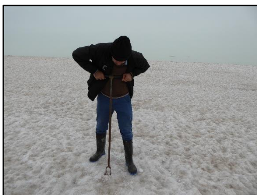
شکل 85) حفاری با اوگر دستی در بستر دریاچه ارومیه
