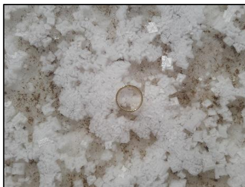
شکل 42) مراحل تشکیل بلور شدگی در سطح محل برداشت نمونه S6
