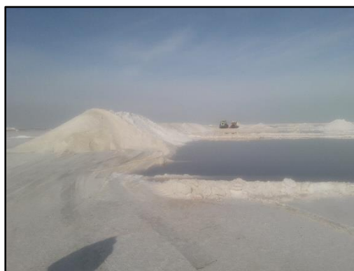
شکل 65) برداشت نمک و حوضچه های شورابه زیر سطحی
