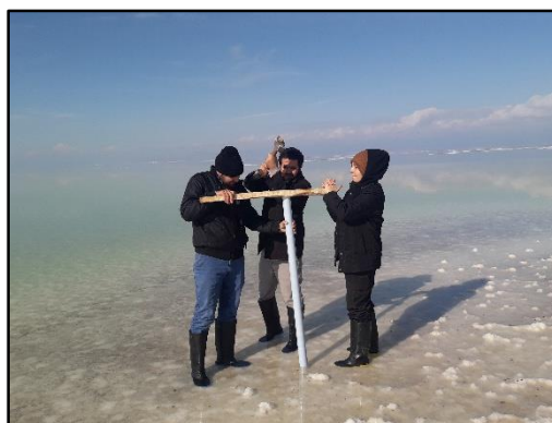
شکل 41) مغزه گیری ضربه ای در لوله پلیکا
