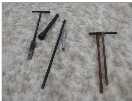
شکل 84) قطعات دستگاه حفاری (اوگر دستی)
