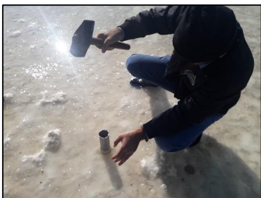
شکل 40) مغزه گیری ضربه ای در لوله فلزی
