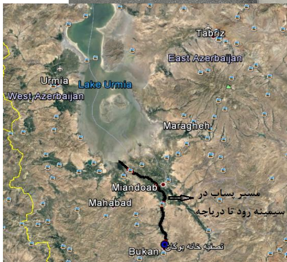
شکل ۸: محل خروج پساب از تصفیه‌خانه شهرستان بوکان (شکل بالا) - مسیر پساب خارج شده از تصفیه‌خانه تا دریاچه ارومیه (شکل‌های پایین): از تصفیه‌خانه تا سیمینه رود به طول ۱۴۵ متر - ادامه مسیر پساب در سیمینه رود تا بستر دریاچه به طول ۱۰۰ کیلومتر
