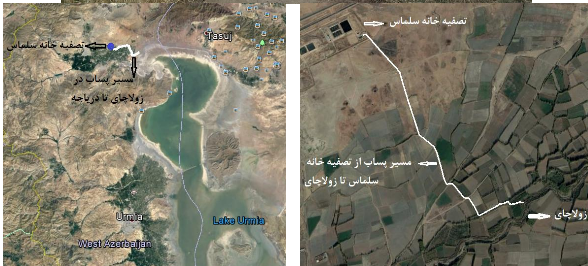
شکل ۹: محل خروج پساب از تصفیه‌خانه شهرستان سلماس (شکل بالا) - مسیر پساب خارج شده از تصفیه‌خانه تا دریاچه ارومیه (شکل‌های پایین): مسیر پساب از تصفیه‌خانه تا زولاچای در کانالی بتنی به طول ۲ کیلومتر - ادامه مسیر پساب در زولاچای تا بستر دریاچه به طول ۱۷/۵ کیلومتر
